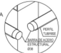
NOTA: CONSIDERAR BARRA DE ACERO ESTRUCTURAL Ø38 EN EL INTERIOR DEL PERFIL TUBIRSE EN EL INICIO Y TERMINO DEL TEJIDO PARA SOPORTAR LA TENSION DEL FLEJE. ESTA SOLUCIÓN SE UTILIZA SI EL PROYECTO LO REQUIERE.
